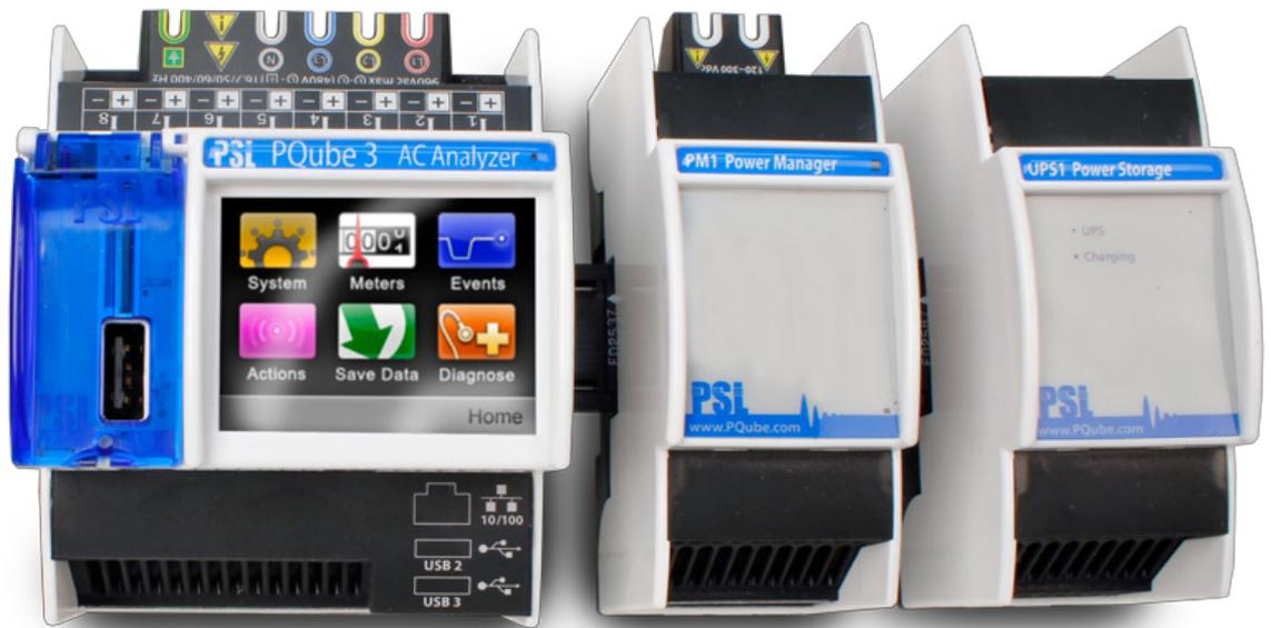
Erfüllt die EN 61000-4-30, Klasse A, Edition 3 Genauigkeitsklasse 0.2/0.2S für Energiemessungen Erfassung von Emissionen zwischen 2 kHz & 150 kHz Aufzeichnung von Hochfrequenz-Impulsen mit 4 MHz, AC & DC -Spannung Temperatur, Luftfeuchtigkeit, Druck, 3-Achsen Beschleunigung
